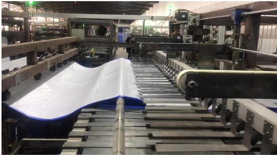
图 2 多轴协同叠布装置
