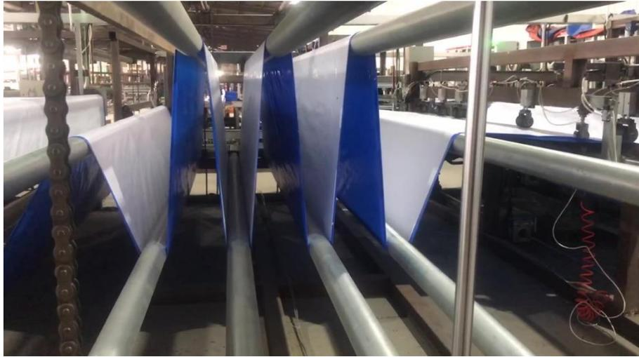
图 1 多轴协同储布装置
