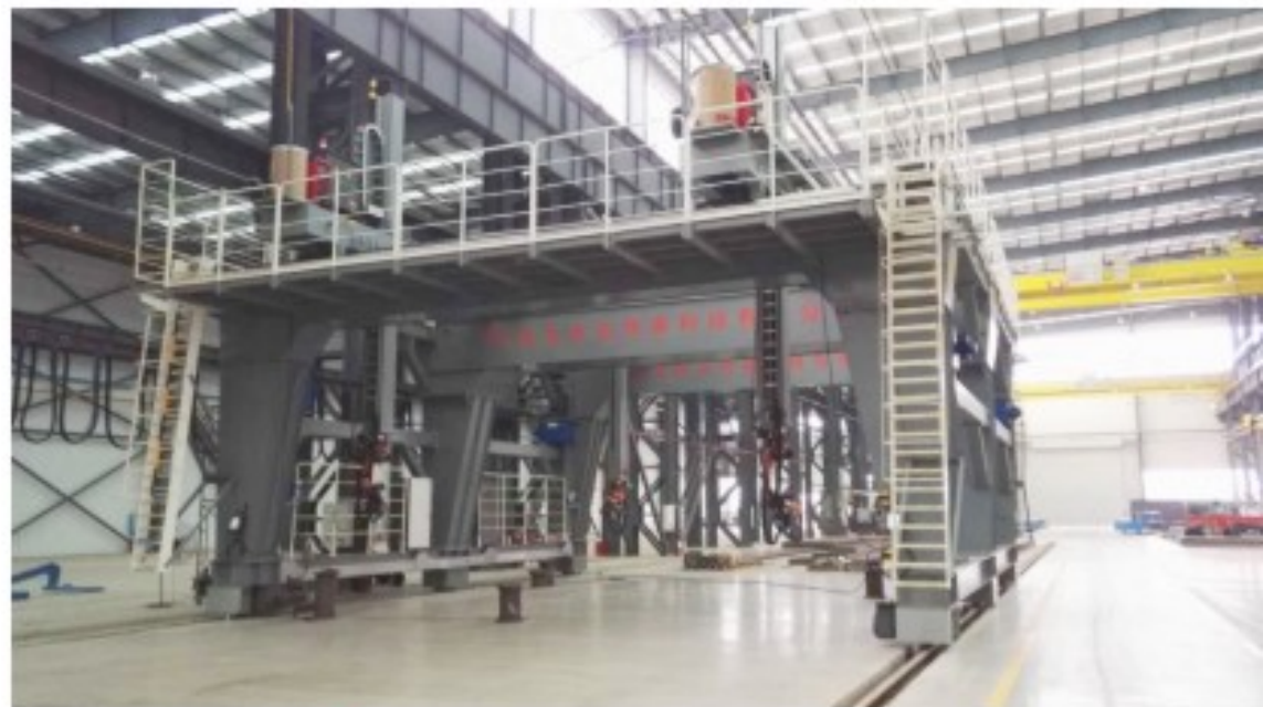
我校自主研发的超大型盾构机刀盘自动焊接工作站
