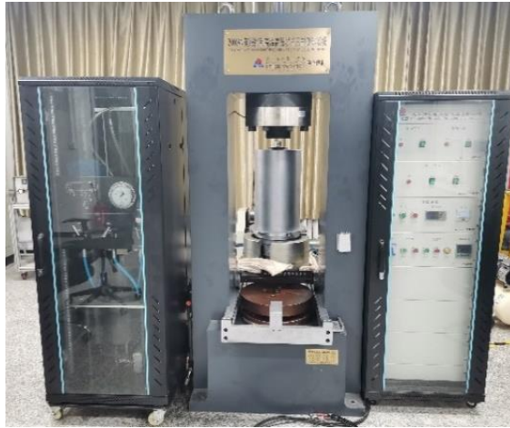
图2 干热岩高温高压水力压裂实验系统
