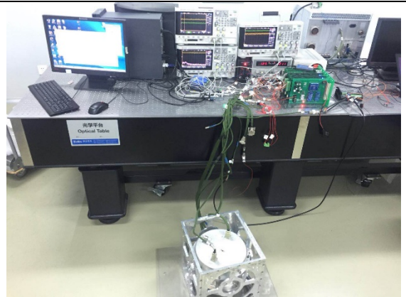
图 2 电性能测试系统
